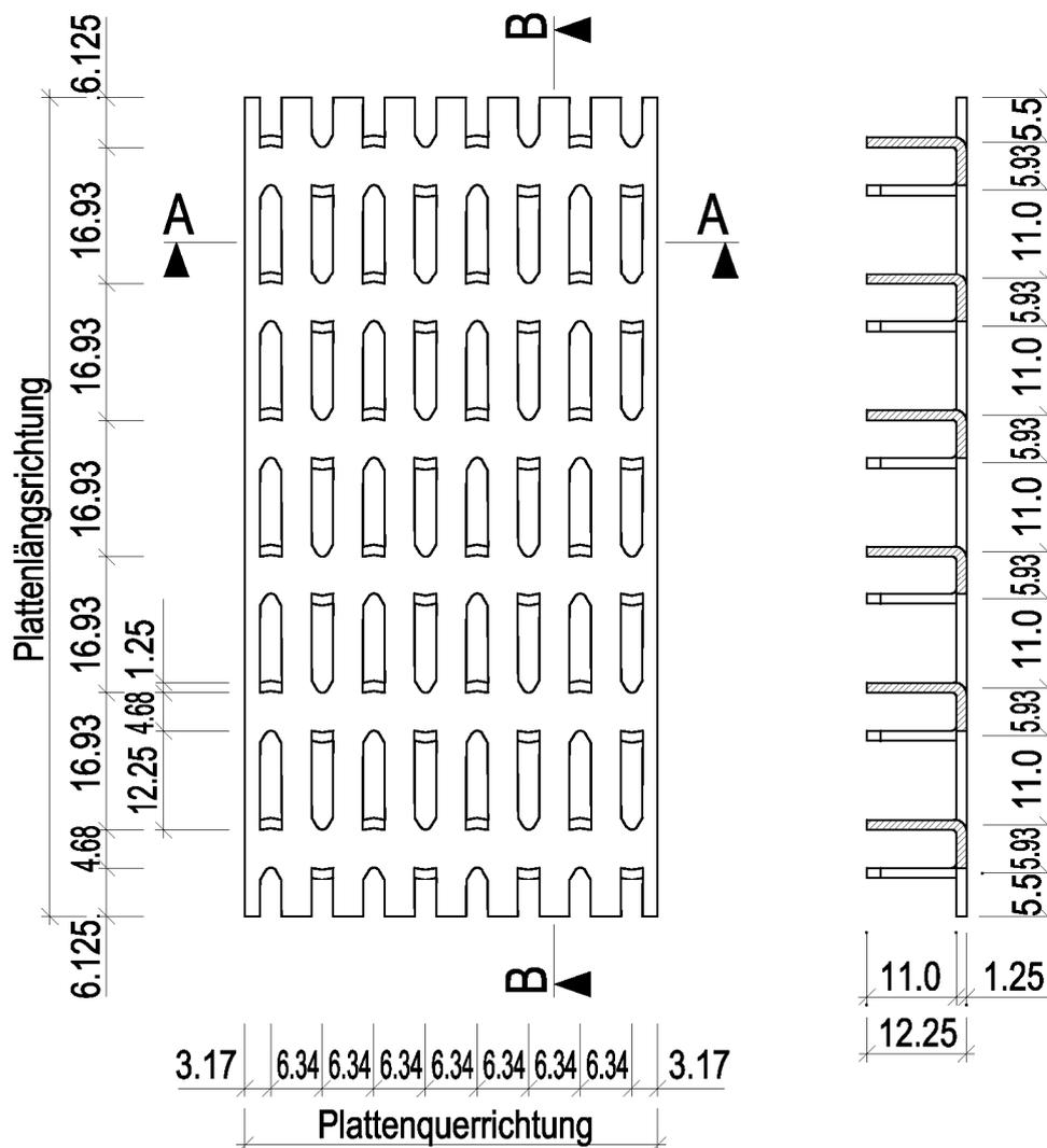
**SCHNITT B-B in Längsrichtung**
