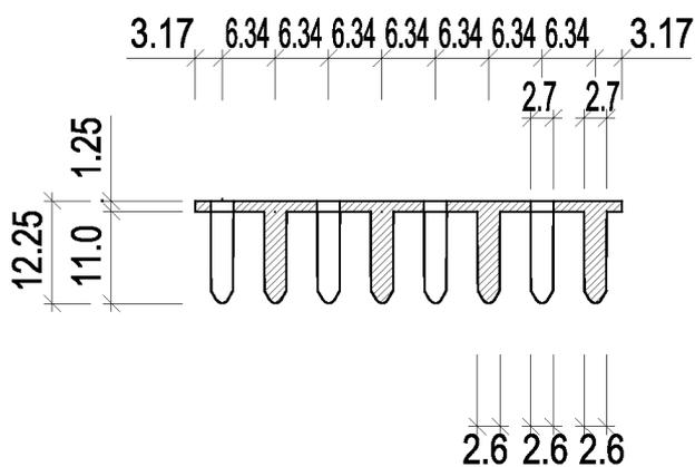
Tragende Holzverbindungen unter Verwendung von Wolf-Nagelplatten 12N und 12NE
